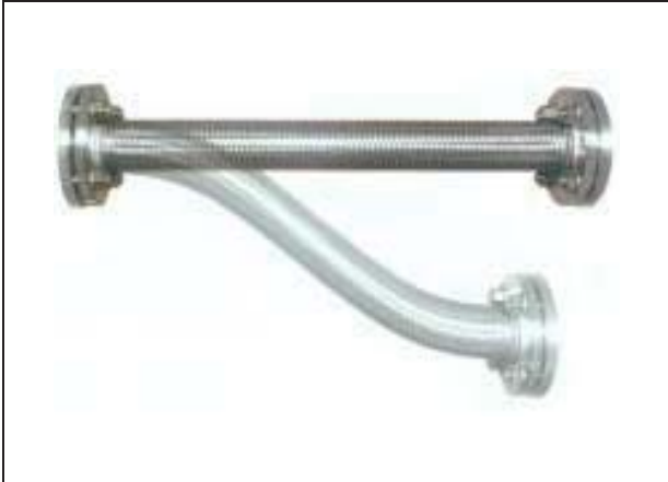
Fig. 1: 直式配管不銹鋼軟管不可作拉伸、或壓縮使用；但可橫向偏移。
