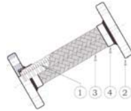
Fig. 2 : 二端固定式法蘭產品結構圖
