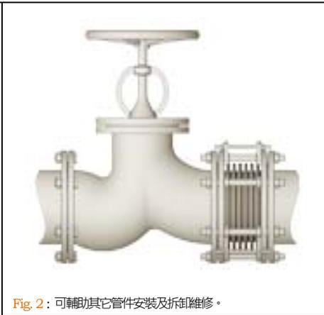
Fig. 2: 可輔助其它管件安裝及拆卸維修。
