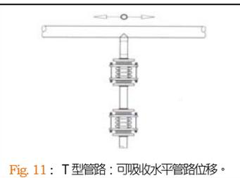
Fig. 11: T型管路：可吸收水平管路位移。
